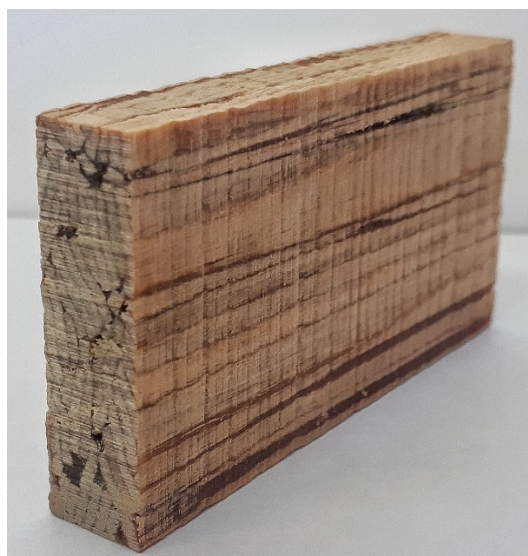
Образец PSL на эпоксидном связующем с карданолсодержащим основанием Манниха
